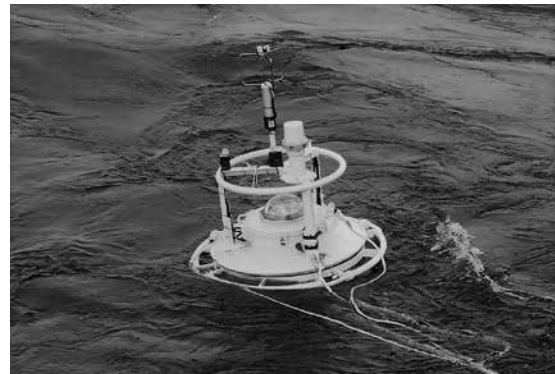
新しく開発した観測ブイで大気・海洋境界面の乱流フラックスを計測する Measurement of turbulent flux at the air-sea interface using a newly developed buoy
